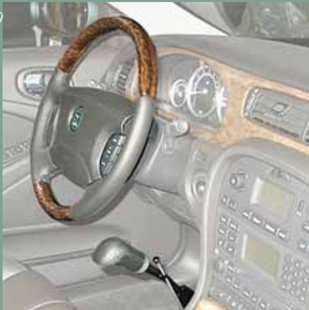
Handbedienung für Bremse (Drücken) und Gas (Ziehen)
