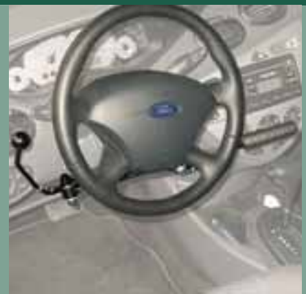
Zweihandbedienung für Bremse (Drücken) und Gas (Ziehen)
