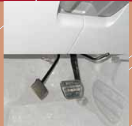
Zusatzgaspedal links, umschwenkbar
