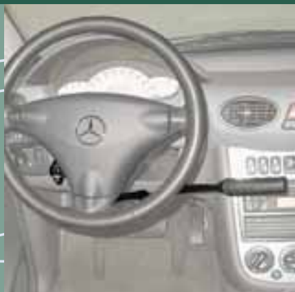
Handbedienung für Bremse (Drücken) und Gas (Ziehen), rechts
