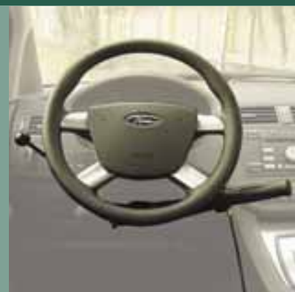
Handbedienung für Bremse und Gas (Zweihandbedienung mit Drehgas)
