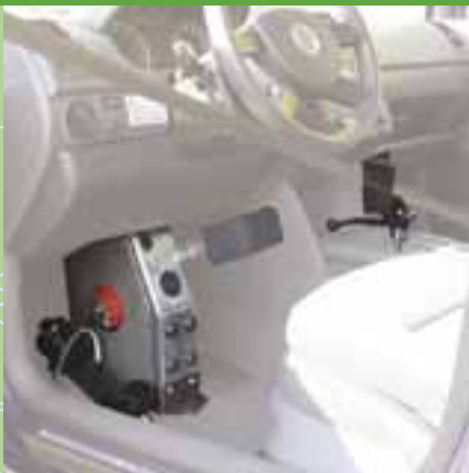
Fußlenkung, System „Fahrrad- kurbel“
