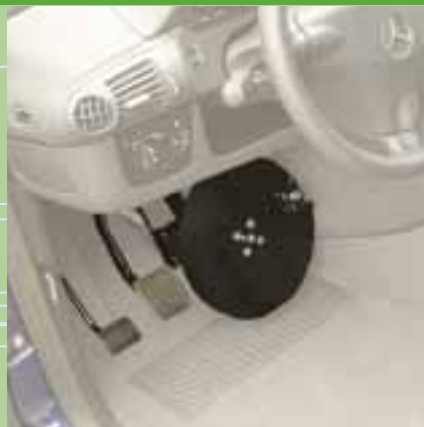
Fußlenkung, System „Dreh- scheibe“
