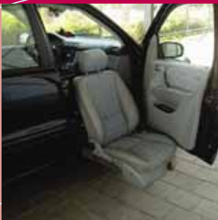
Schwenksitz mit elektrischer Absenkfunktion
