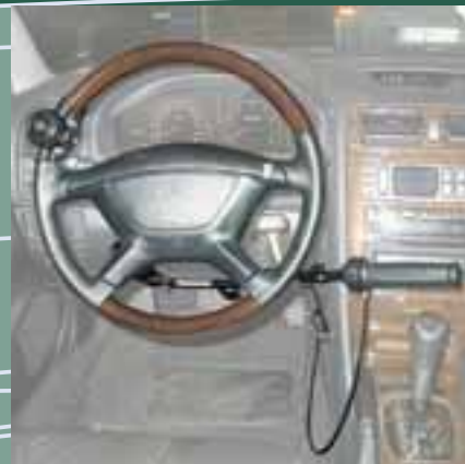
Handbedienung für Bremse (Drücken) und Gas (Drehen)
