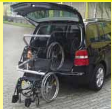
Automatische Verladehilfe bis 110 Kg
