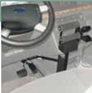
Handbedienung für Bremse (Drücken) und Gas (Ziehen)
