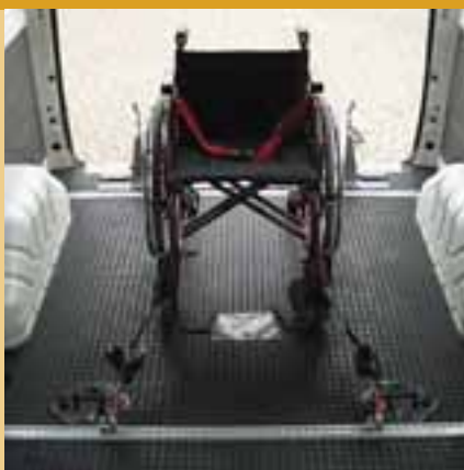
Rasterschienen mit 4-Punkt-Rollstuhlhalterung
