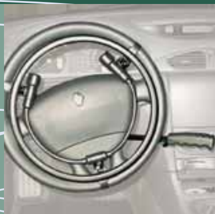
Gasring (elektrische Bedienung für Gas)
