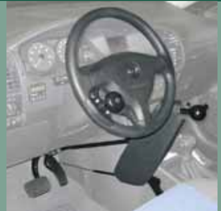
Handbedienung für Bremse (Drücken) und Gas (Drehen)
