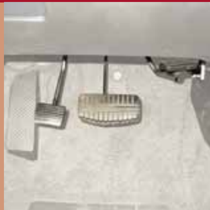
Zusatzgaspedal links, hochklappbar
