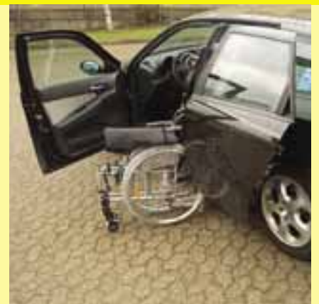
Seitliche Verladevorrichtung System „Rausch“
