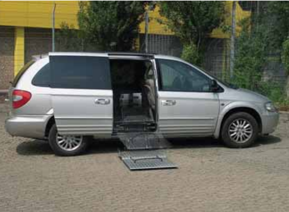
Automatische Verladevorrichtung für schwere Elektro-Rollstühle und Scooter
