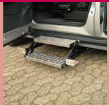
Trittstufe, elektrisch ausfahrbar, zwei Stufen
