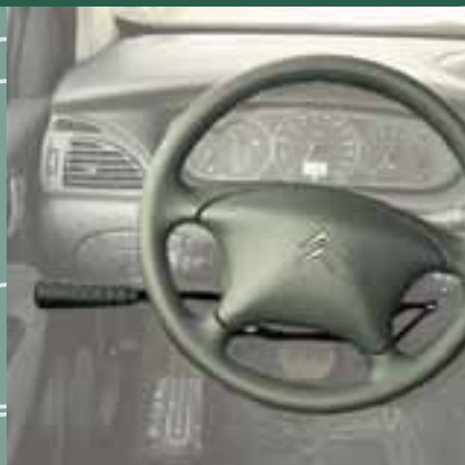
Handbedienung für Bremse (Drücken) und Gas (Ziehen), links
