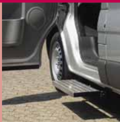
Trittstufe, elektrisch ausfahrbar, eine Stufe
